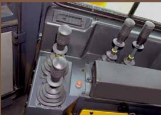
Два передних рычага управляют лебедками подъемного оборудования трубоукладчика, боковые рычаги приводят в действие противовесы, которые поддерживают стабильность машины.
