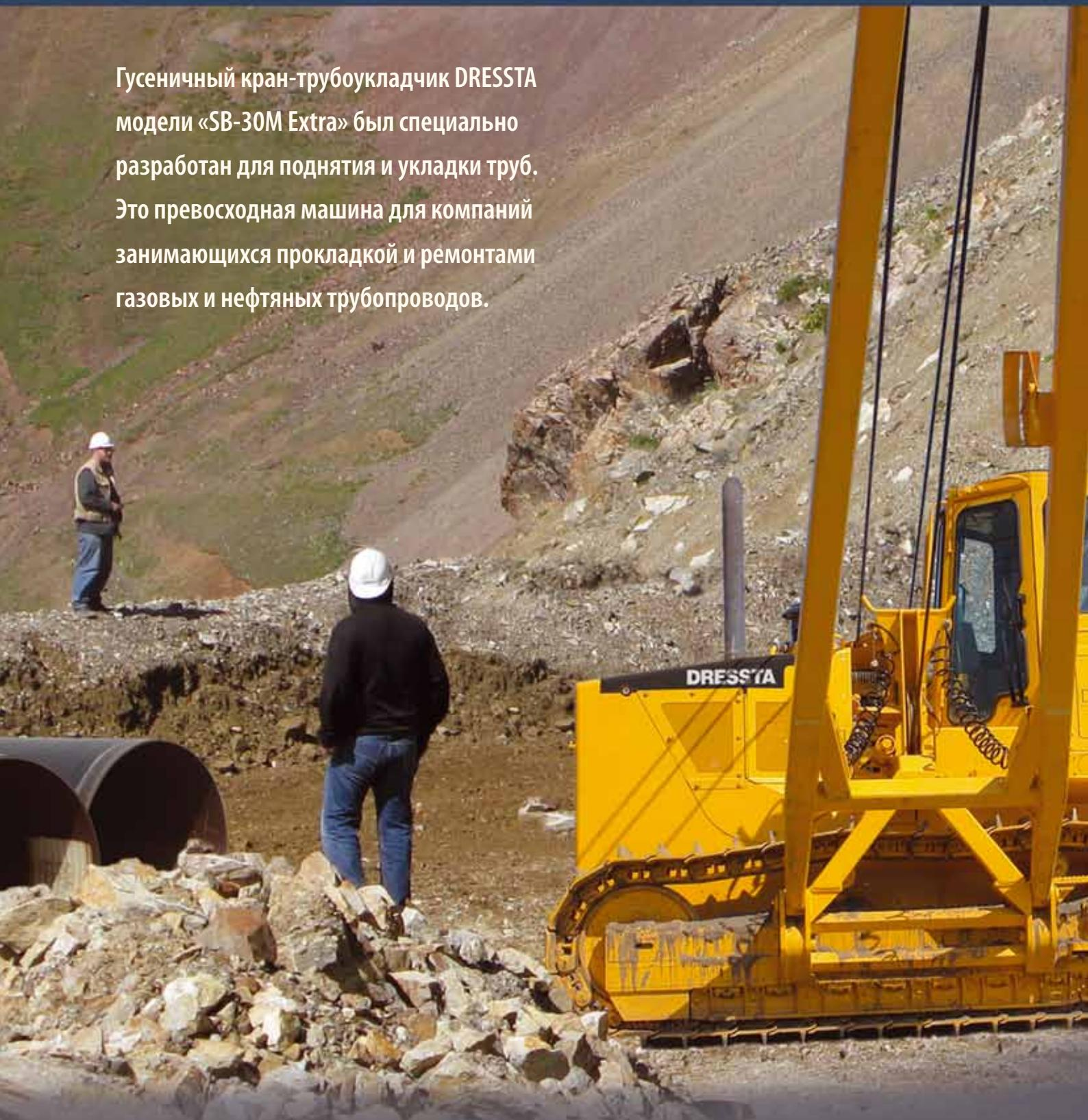
Безопасность работы обеспечивается с помощью аварийной системы стрелы, ограничителя подъема крюка и преобразователя
