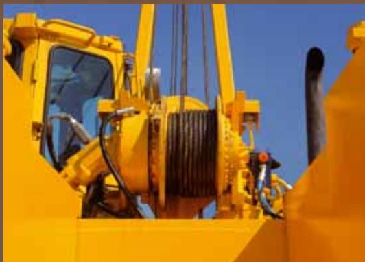
Две независимо управляемые гидравлические лебедки приводят в действие стрелу и крюковую подвеску.
